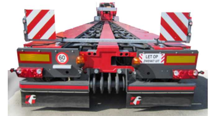
Iluminación con parachoques y paneles de aviso
