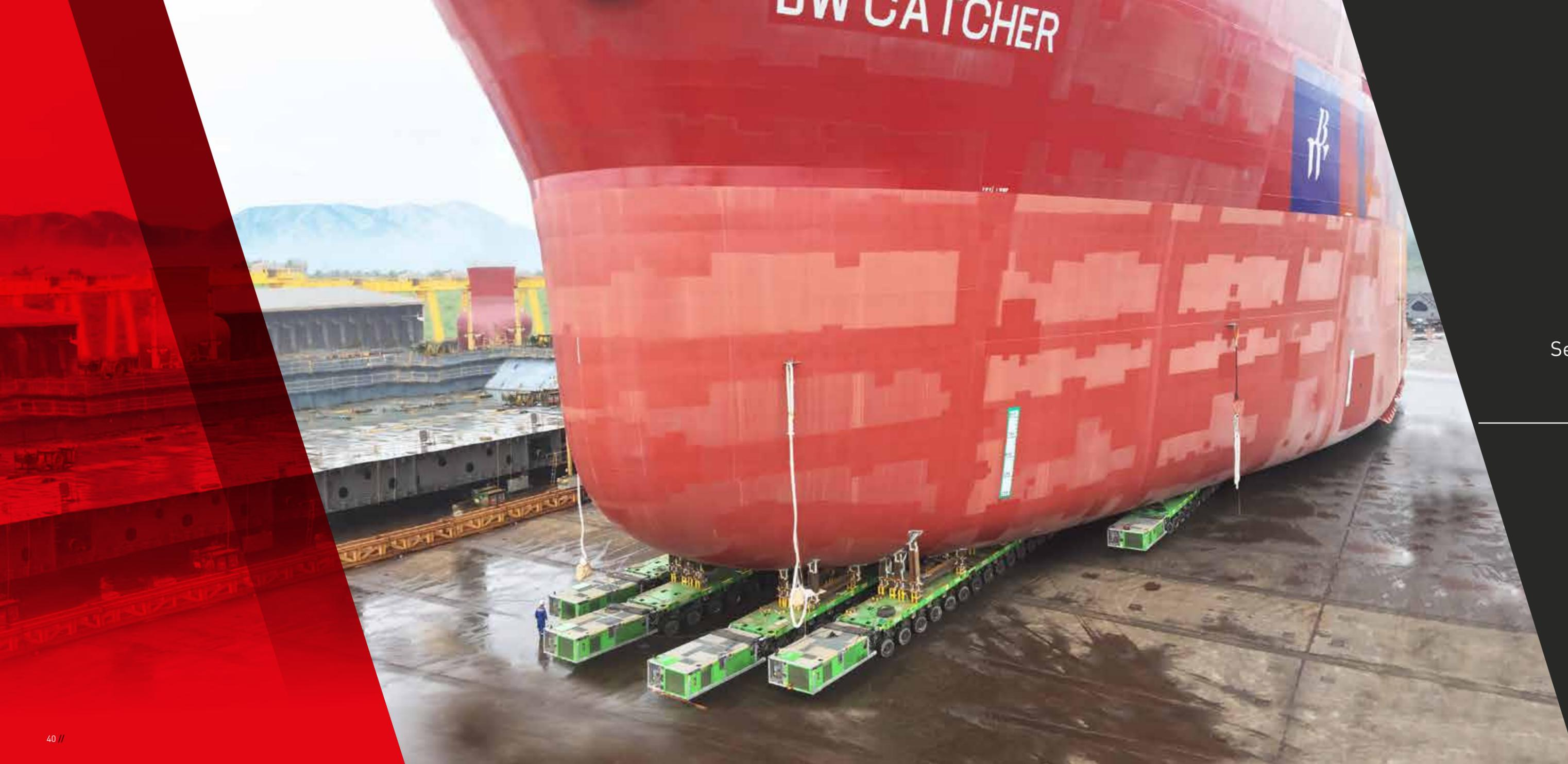
Selbstangetriebene Modulfahrzeuge, Schwerlastmodule und
